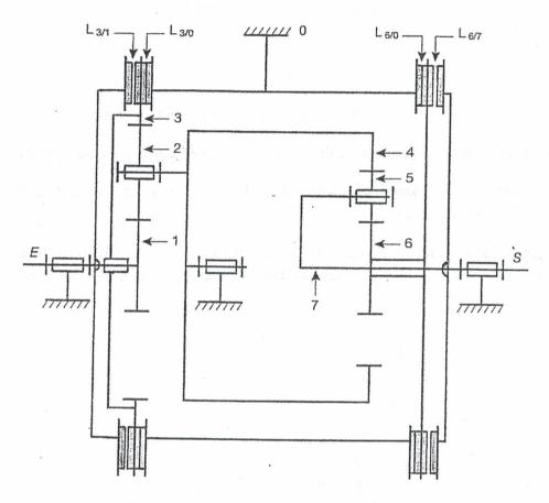
L'arbre d'entrée (E) de la boîte de vitesses est solidaire de l'arbre de sortie du moteur du véhicule. L'arbre de sortie (S) entraîne les roues de la voiture par l'intermédiaire du "différentiel".
