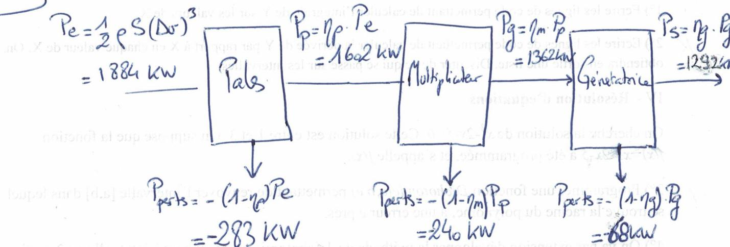
II) 3) On applique le TEC à l'ensemble {pales; multiplicateur; arbre de génératrice} mais on néglige les moments d'inertie des arbres du multiplicateur et de la génératrice. On obtiendra en sortie le couple à l'entrée de la génératrice
