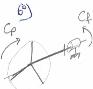
En statique,  $C_f$  s'oppose à  $C_p$  avec  $v = 3 \text{ m} \cdot \text{s}^{-1}$ .
