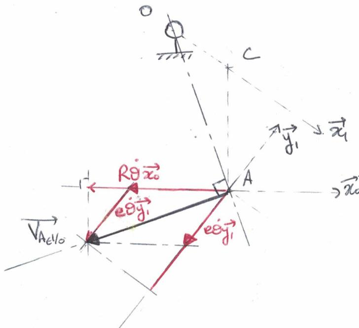
4°) Si  $\vec{\omega}_{210} = \vec{0}$  alors le mouvement est une translation de direction  $\vec{y}_0$ . (La mobilité en rotation de la pivot glissante culasse/soupape n'est pas utilisée).
