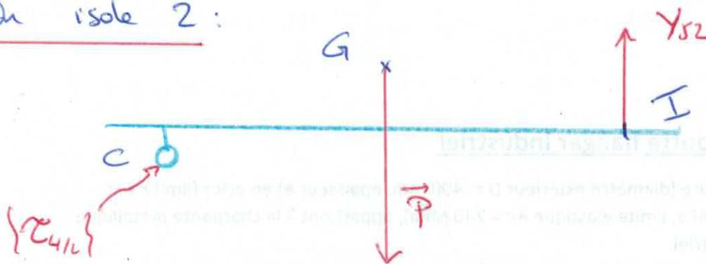
BANE :  $\{ \tilde{Z}_{5/2} \} = \begin{Bmatrix} 0 & \phi \\ Y_{52} & \phi \\ I & \phi & 0 \end{Bmatrix}_{B_0}$  on pose  $Y_{52} > 0$  car le galet exerce un effet positif sur 2.
