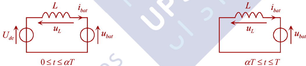
Figure 9 : schémas électriques équivalents pour chaque phase de fonctionnement
